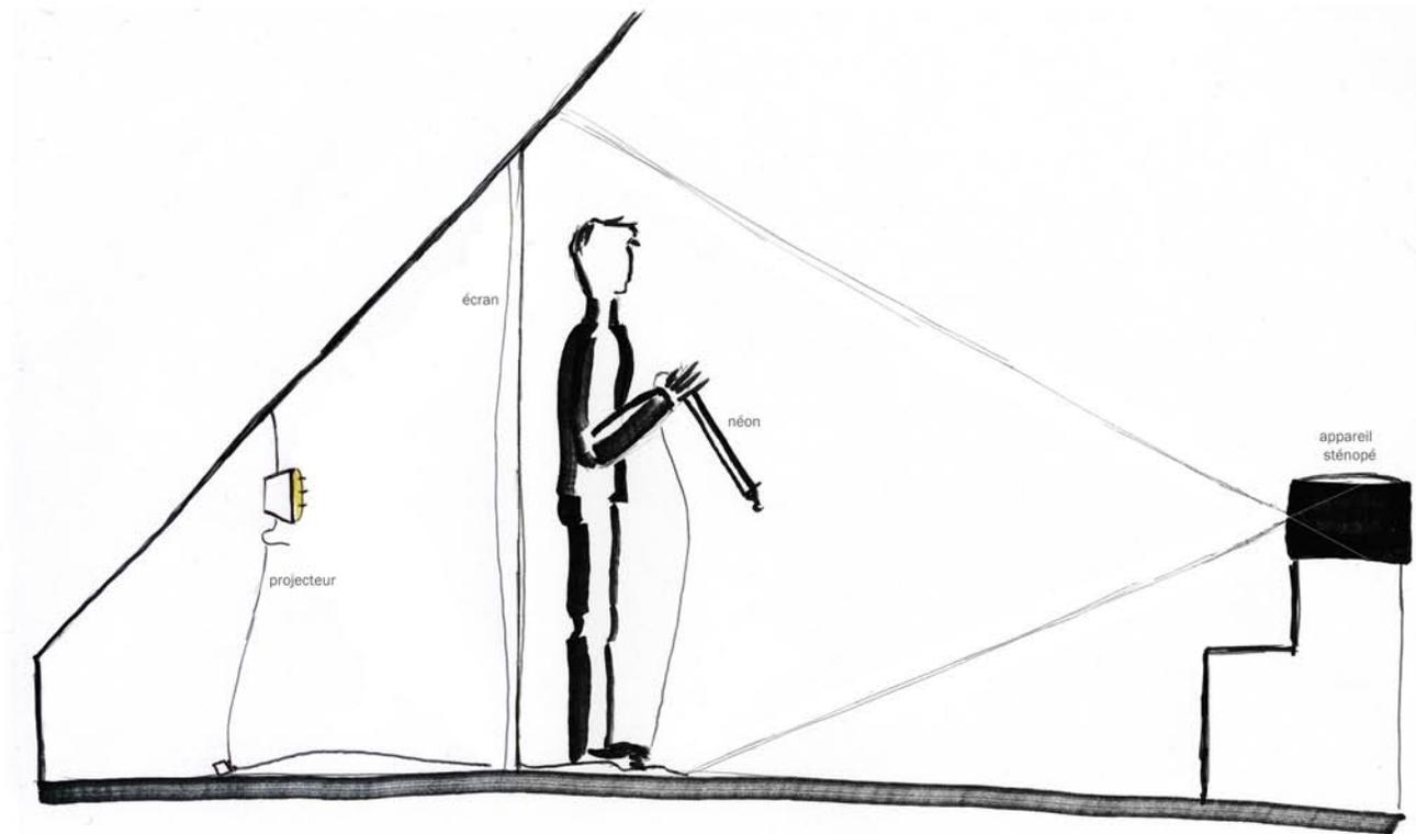
Vue de profil du dispositif de prise de vue à l'appareil sténopé
